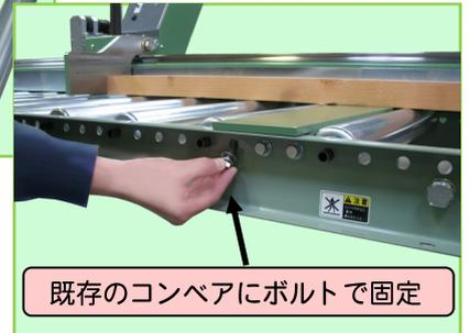
既存のコンベアにボルトで固定
